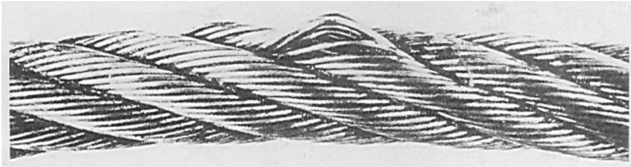
Abb. 4 - Ein Kardeel, das nur vom Auswurf von Litzen betroffen ist, wenn auch die Kontrolle auf einem Seilstück zeigt, dass die Deformation in regelmäßigen Abständen sichtbar ist, die normalerweise der Länge einer Umwicklung entspricht.
