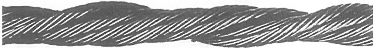
Abb. 7 - Örtlich begrenzte Verminderung des Seildurchmessers, weil die äußeren Kardeele den Platz der Seele einnehmen, die zerstört ist. Auch das Vorhandensein von gebrochenen Litzen ist sichtbar.
