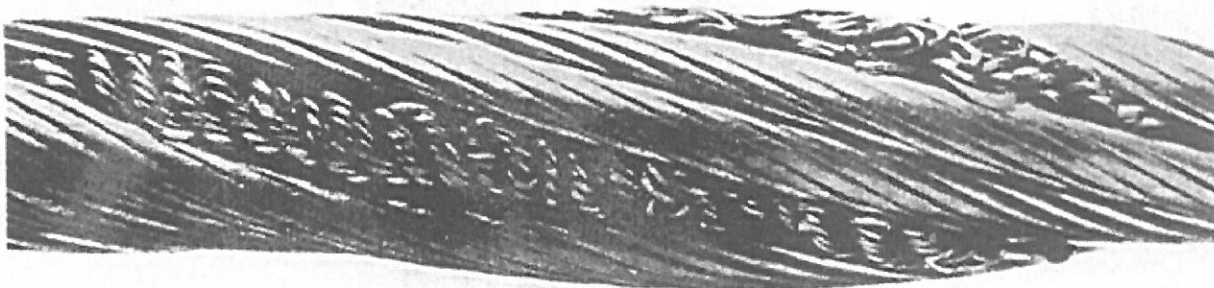
Abb. 6 - Örtlich begrenzte Erhöhung des Durchmessers eines Seils mit Parallelwicklung, verursacht durch die Verzerrung der Seele, verursacht durch eine plötzliche Last. Bedingung, die den sofortigen Austausch erfordert.
