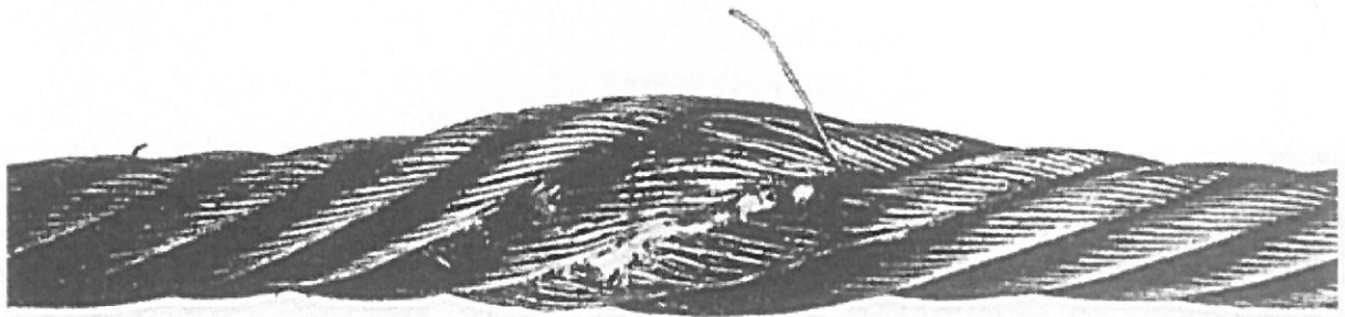
Abb. 8 - Abgeflachtes Teilstück, das durch eine örtlich begrenzte Quetschung verursacht wurde, die ein Ungleichgewicht in den Kardeelen bewirkt. Gleichzeitig Vorhandensein von gebrochenen Litzen. Bedingung, die den sofortigen Austausch erfordert.
